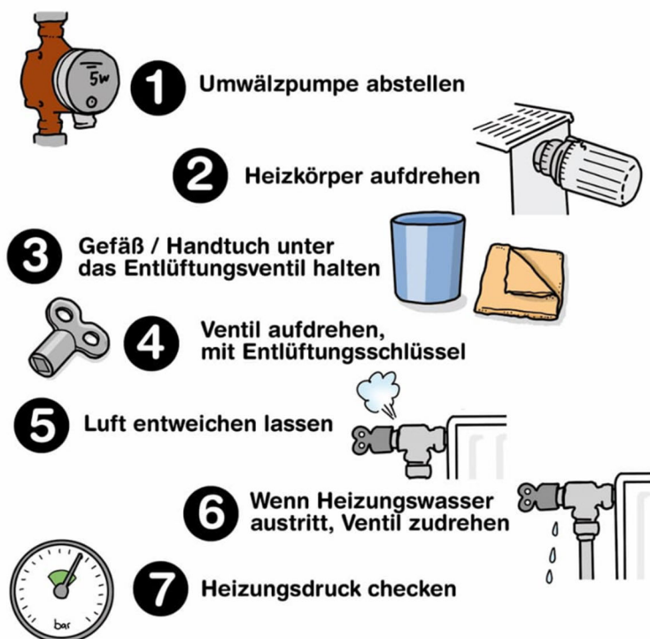
Abbildung 3: Heizung entlüften Schritt für Schritt (Bildquelle: heizsparer.de )
